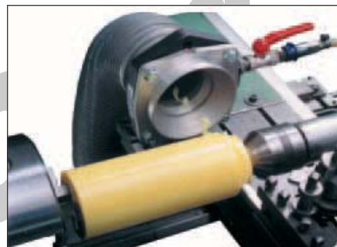
Rundtransvektoren sorgen für die effektive Entfernung von Beschnittresten und Abfall.
