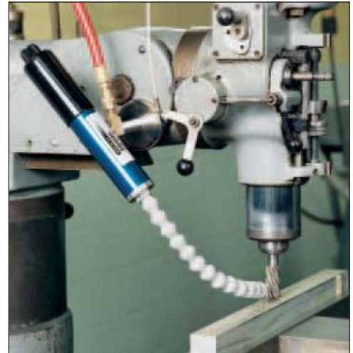
Durch Verwendung der stufenlos einstellbaren Kaltluftpistole Modell 610BSP zur Punktkühlung von Werkstücken und industriellen Prozessen werden die Produktionszahlen gesteigert und die Werkzeugstandzeiten verlängert.
