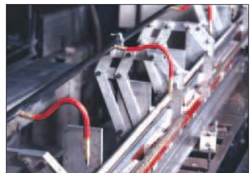
1204 Flexible Düsen im Buchbindemachine
